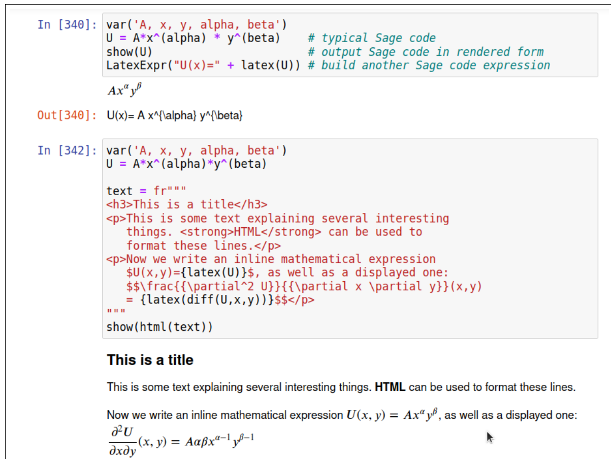
Abb. 16: Verwendung von Text und Code in einer Code-Zelle des Jupyter-Notebooks
