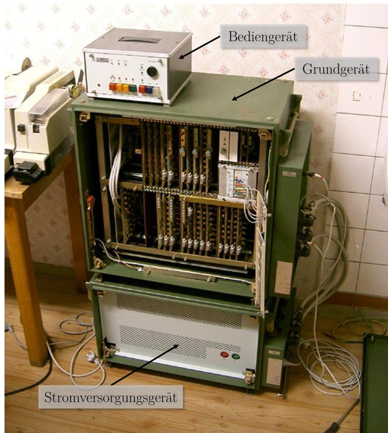
**Abbildung 2.1:** Das T-310/50-Gerätesystem – die Beschriftungen zeigen auf die jeweiligen Komponenten. Das ursprüngliche Foto stammt aus [3].
