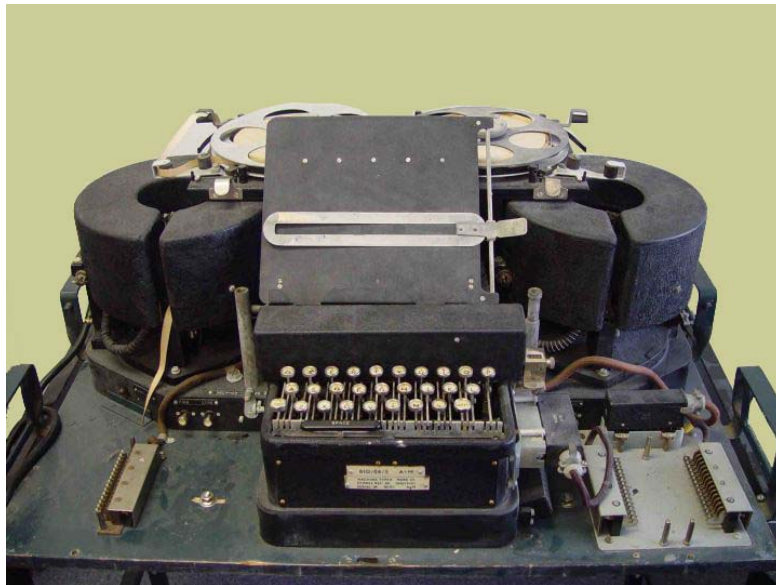
Abbildung 3.3: Typex-Chiffriermaschine mit Druckfunktion [26]
