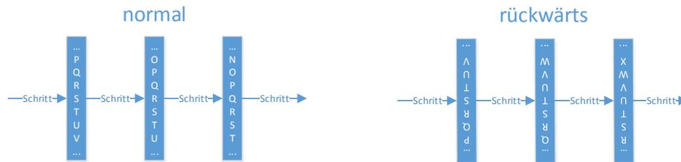
Abbildung 3.3: Schematische Darstellung der Fortschaltungen eines Rotoren
